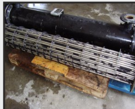
Ölkühler für Motorenöl, Härteöl und mehr
